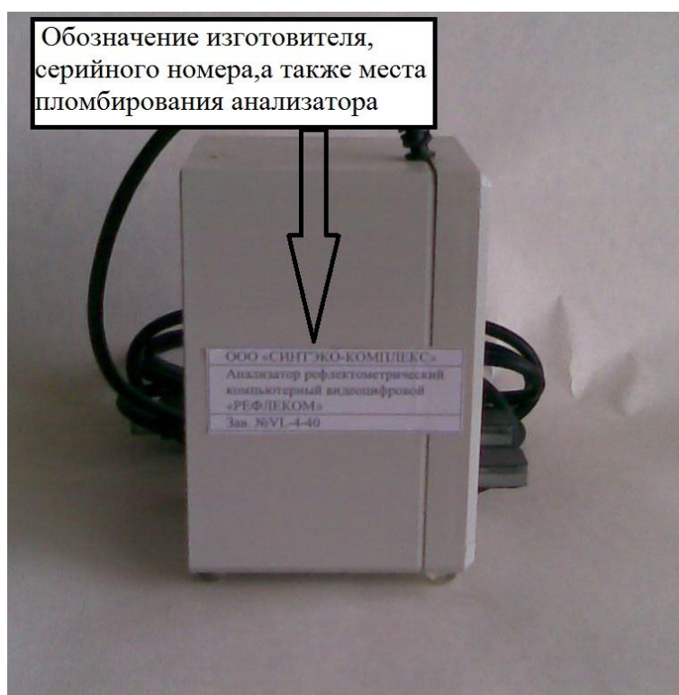
Рисунок 2 - Вид боковой стороны анализаторов с обозначением схемы пломбирования и маркировки
